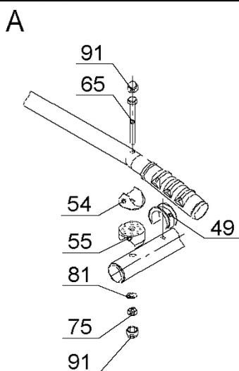
**В:** Установка Перекладины в сборе поз.52 на Укос в сборе поз. 53
