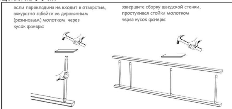
4.2.4. Разложить зеркально стойки (№1). Вставить ступени-поперечины (№9) в соответствующие отверстия стоек (№1) (рисунок 2). С помощью саморезов (№10) и шайб (№11) закрепить поперечины к стойкам. Установить заглушки (№12) (рисунок 1).
