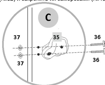
4.4.8 Собрать и установить зацепы скалодрома (№35) и закрепить, используя винты (№36) и гайки (№37) следуя схеме на рисунке 6 примечание С
